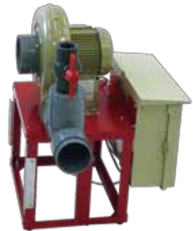
ファン圧送部
